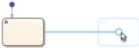
Fig. 8: Combinare transizioni e giunzioni per creare percorsi ramificati. Blocco connective junction .
